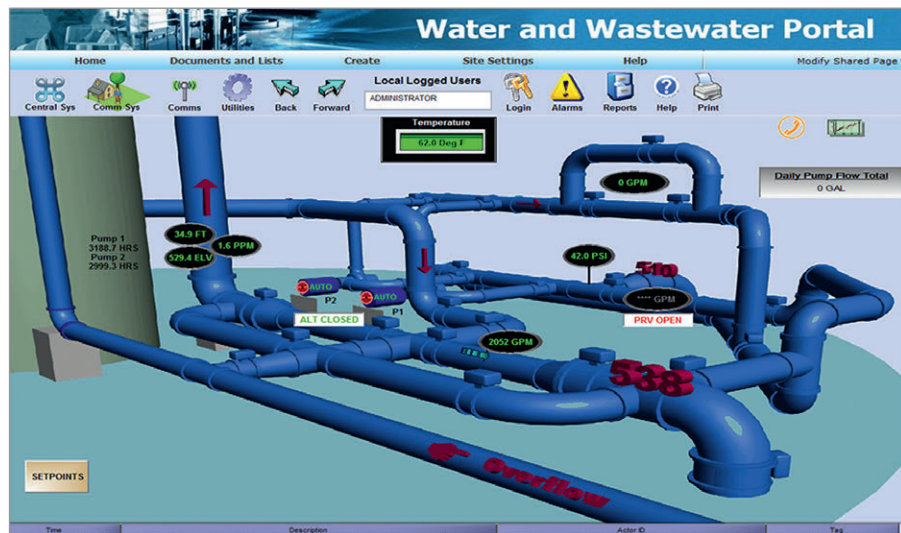
Рис. 4. Пример экранной формы диспетчера насосной станции
