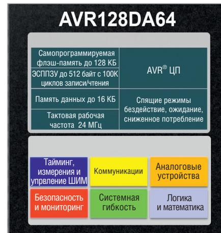
Рис. 12. Структура микроконтроллеров AVR-DA
