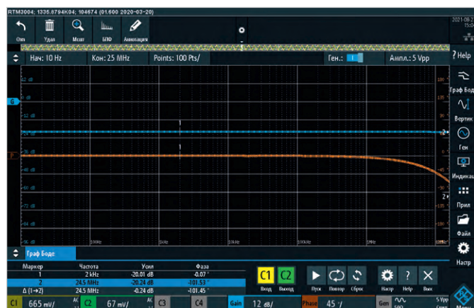
Рис. 7. Результат построения диаграммы Боде для аттенюатора
