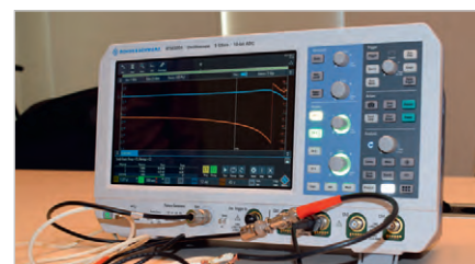
Рис. 6. Фотография измерительной установки для построения диаграммы Боде в целях расчёта функции Z(f)
