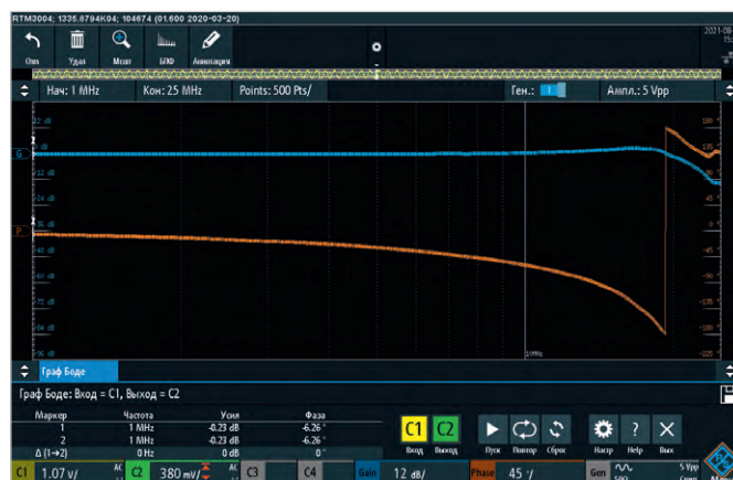
Рис. 8. Диаграмма Боде, построенная с использованием схемы измерений на рис. 3
