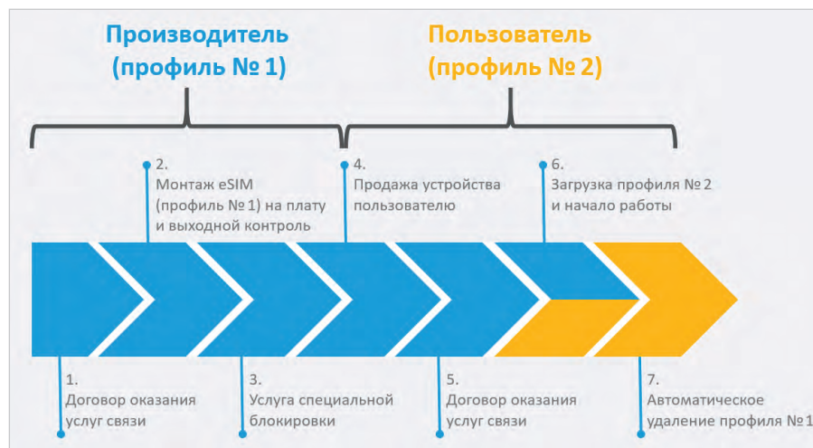
Рис. 3. Переход устройства с eSIM от производителя к пользователю
