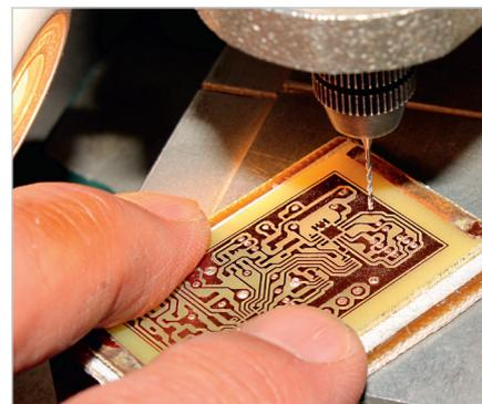
Рис. 35. Процесс сверления платы
