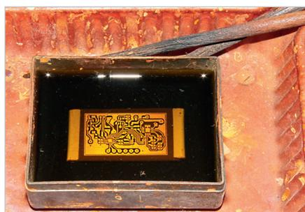
Рис. 23. Травление заготовки в хлорном железе
