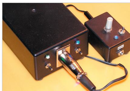
Рис. 32. Подключение линейного стабилизатора к блоку питания
