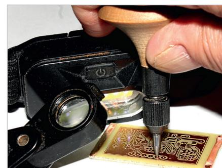
Рис. 25. Процесс кернения
