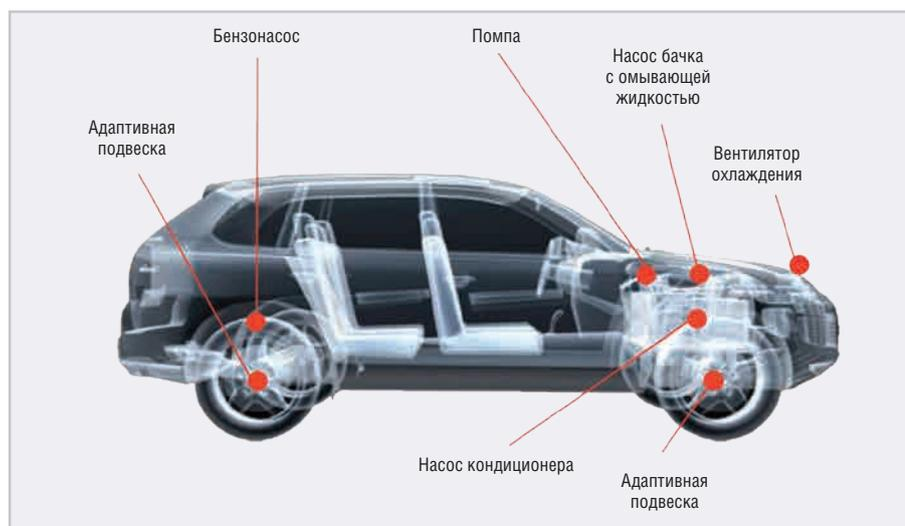
Рис. 1. Примеры применения электродвигателей в автомобилях
