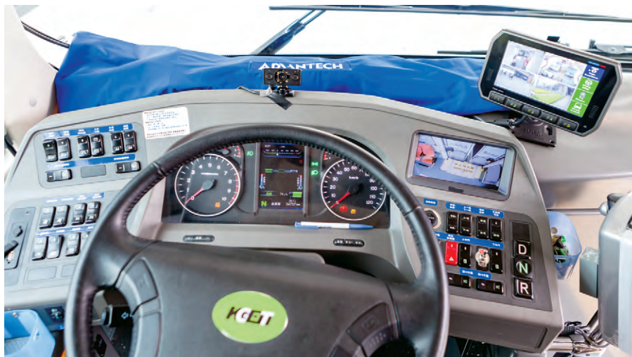
Рис. 3. В кабине электробуса с системой управления Advantech
