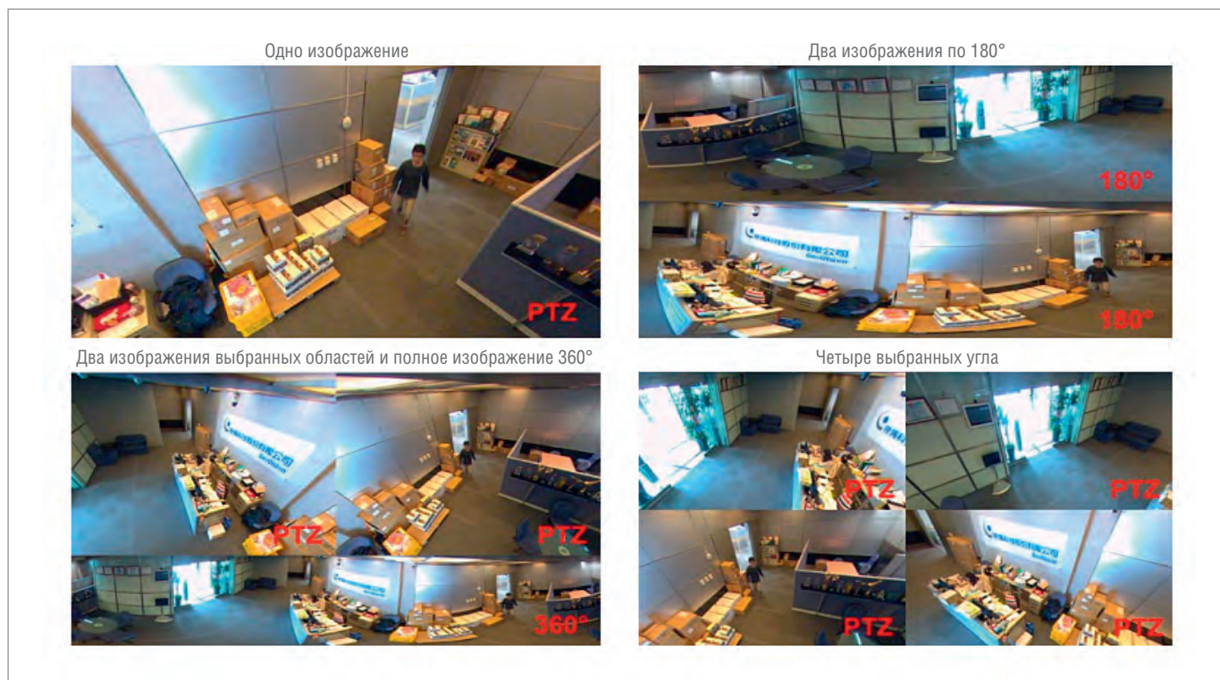
Рис. 3. Развёртка изображения камеры с объективом «рыбий глаз»
