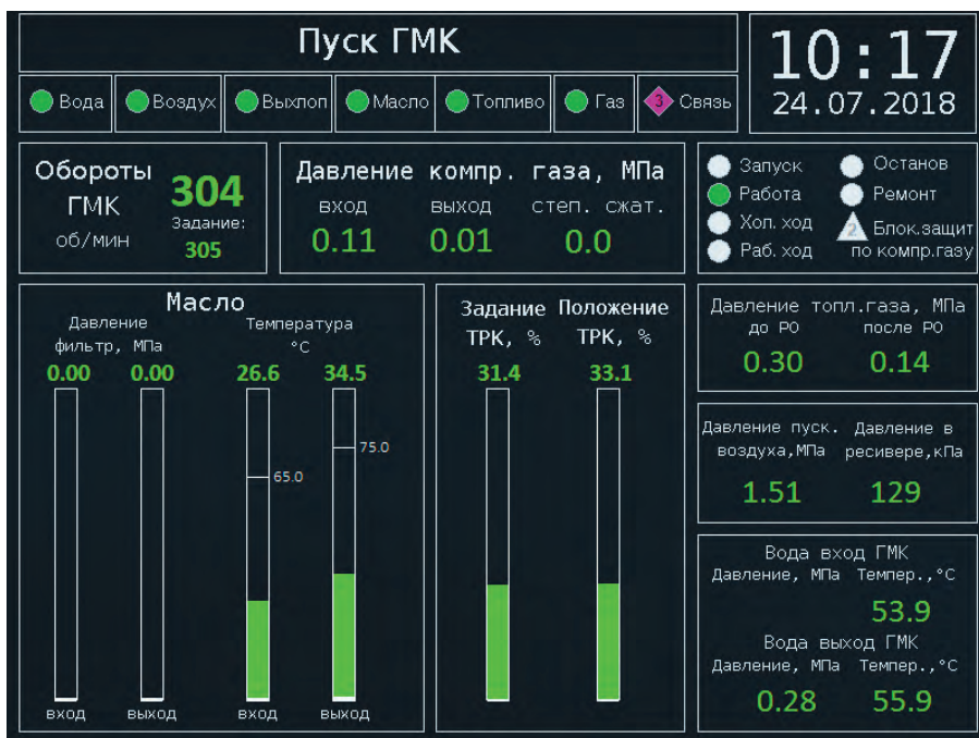
Рис. 5. Интерфейс пульта резервного управления ГМК
