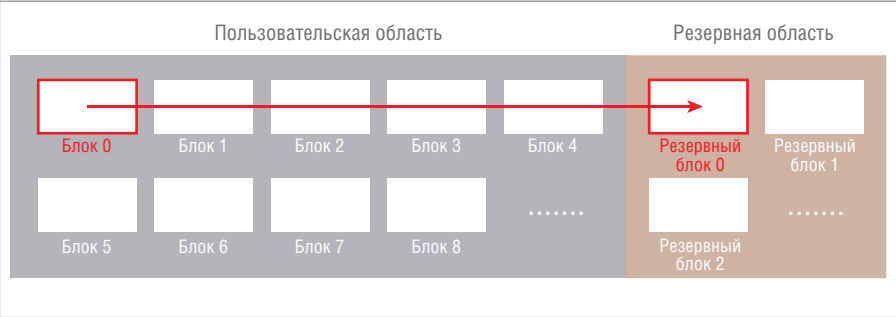
Рис. 4. SSD начинает запись в резервный блок 0
