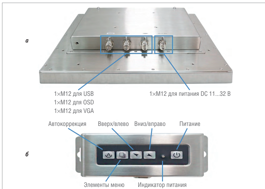
Рис. 9. Вид коннекторов (а) и вынесенного блока OSD (б) взрывозащищённого дисплея серии AEx
