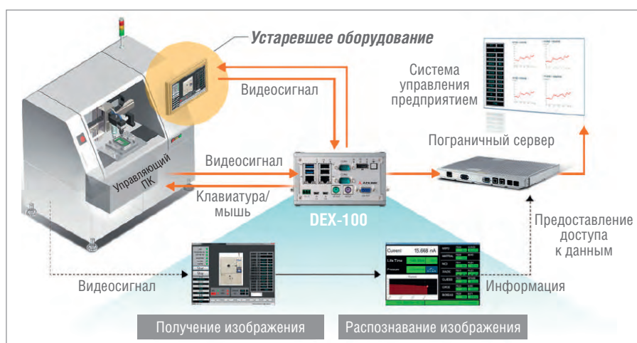
Рис. 3 . Распознавание экранных форм на базе ADLINK DEX-100
