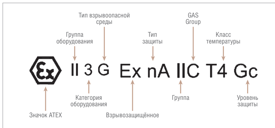
Рис. 5. Пример европейской маркировки взрывозащищённых изделий
