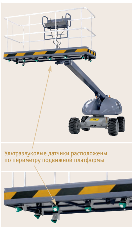
Рис. 8. Ультразвуковые датчики контролируют опасное сближение платформы с посторонними объектами
