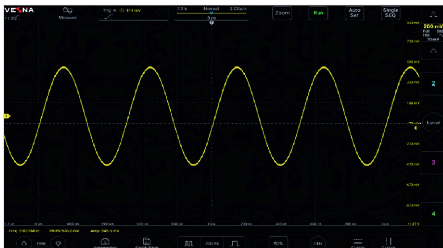
Рис. 8. «Эталонная» осциллограмма ИС без аддитивного шума и результаты автоматических измерений
