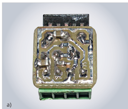
Рис. 12. Внешний вид платы преобразователя +28 В в -28 В на базе ОУ LM675Т: а – вид со стороны разводки, б – вид с обратной стороны
