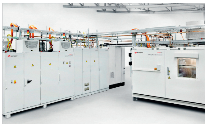
Рис. 4. Система тестирования батарей Keysight серии Scienlab SL100XA
