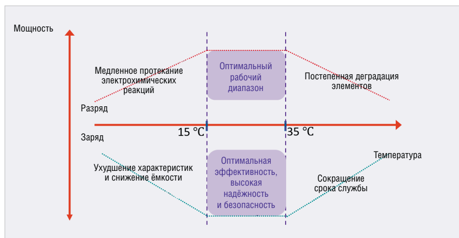
Рис. 1. График зависимости мощности от температуры показывает пределы мощности элемента или АКБ в диапазоне температур (источник: Kandler Smith, NREL milestone report, 2008)
