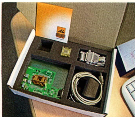
Рис. 2. Внешний вид набора программных и аппаратных средств поддержки разработок на МК типа 1886BE4U
