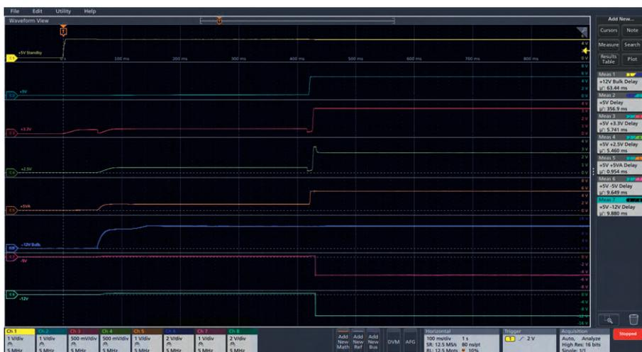
Рис. 4. Отображение последовательности включения семи стабилизированных источников питания
