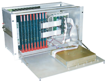
Блок контроля реактивности и регулирования мощности БНО-70Р
