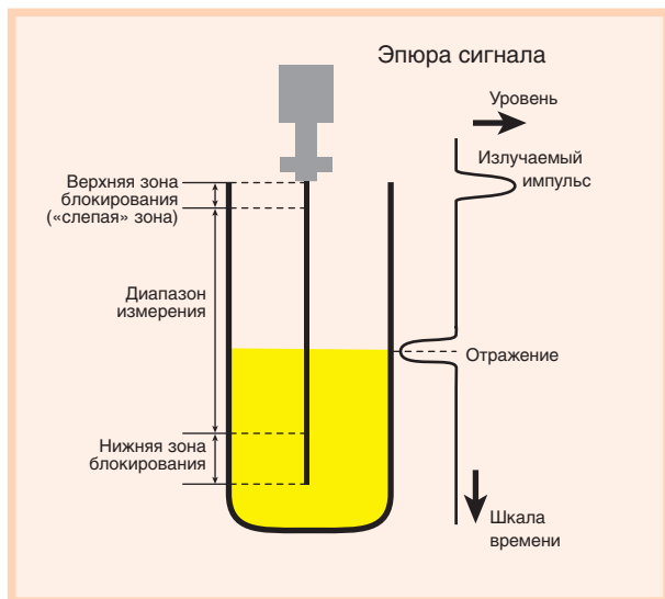
Рис. 11. Принципы измерения методом направленного электромагнитного излучения
