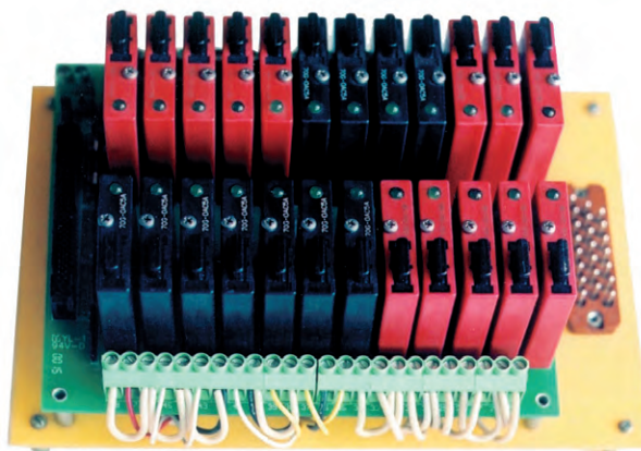
Рис. 7. Блок управления дискретной электроавтоматикой станка на основе твердотельных модулей Grayhill
