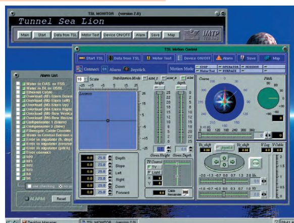
Рис. 6. Примеры окон интерфейса оператора подводного аппарата TSL
