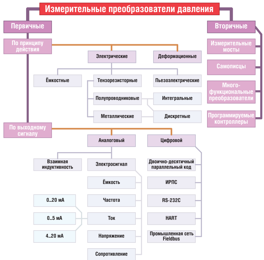
Рис. 4. Классификация измерительных преобразователей давления
