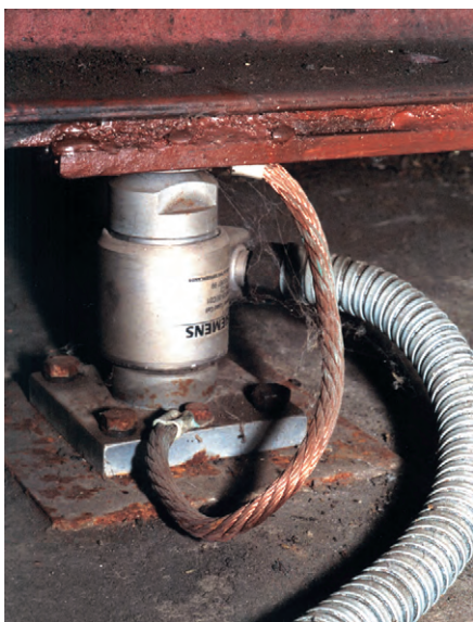
Рис. 1. Тензометрический датчик SIWAREX M с узлом сборки
