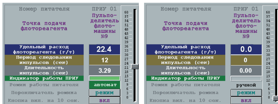
Рис. 5. Вид видеопульта управления питателем № 1 в автоматическом (слева) и ручном (справа) режимах
