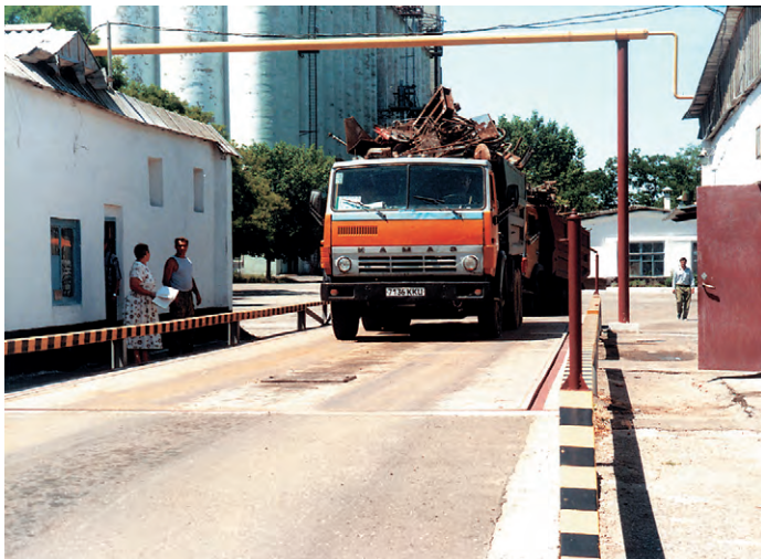
Рис. 5. Ейский портовый элеватор: автомобильные весы 2РС60-ДА
