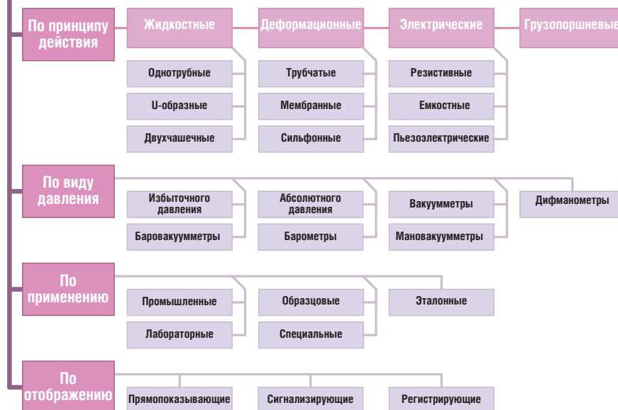
Рис. 3. Классификация манометров
