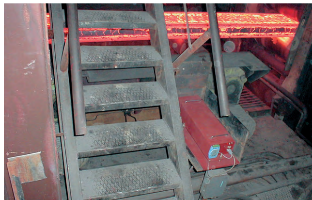
Рис. 6. Расположение оптического измерителя на МНЛЗ
