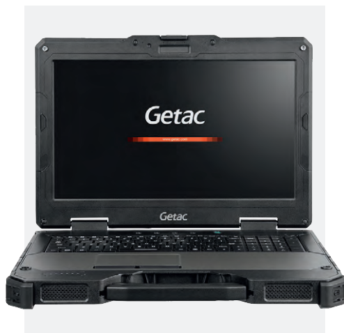
Рис. 8. ПАК на базе защищённого ноутбука Getac X600 с предустановленным АПМДЗ «Соболь 4»
