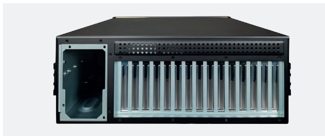
Рис. 2. Задняя часть корпуса для системы на основе объединительных панелей PICMG 1.3
