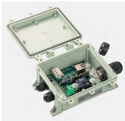
Рис. 4. MC31 для подключения уличного SIP-телефона
