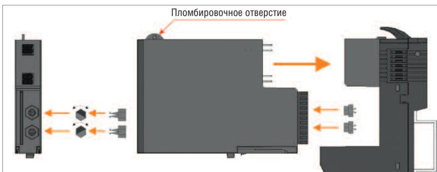
Рис. 7. Кодирование электронных блоков
