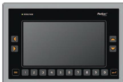
Рис. 1. Вид передней панели контроллера R400
