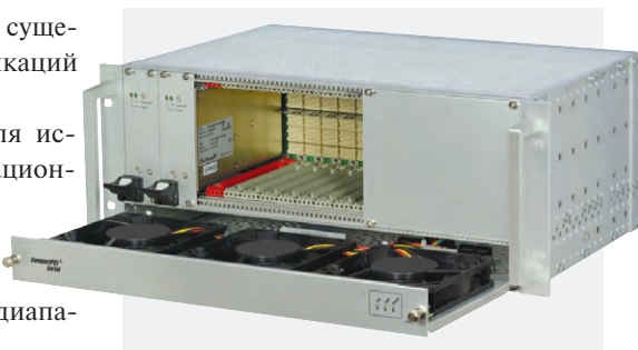
Рис. 5. Шасси для ММС стандарта CompactPCI Serial с резервированным блоком питания
