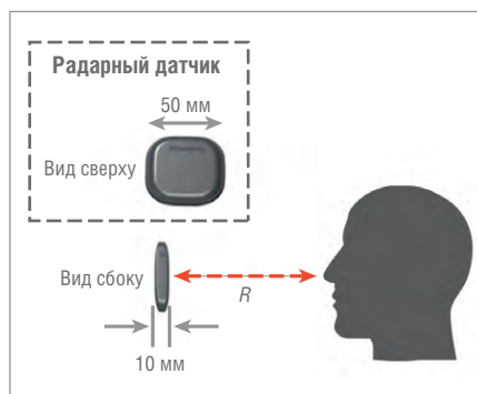
Рис. 2. Экспериментальная установка для сбора данных с радиолокационных датчиков
