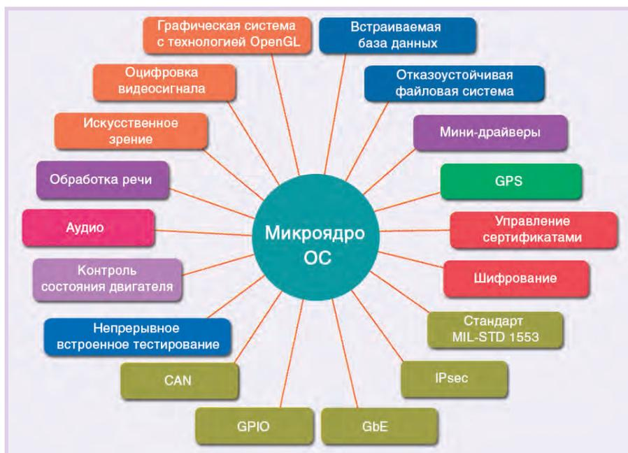
Рис. 1. Подключение программных компонентов в микроядерной операционной системе
