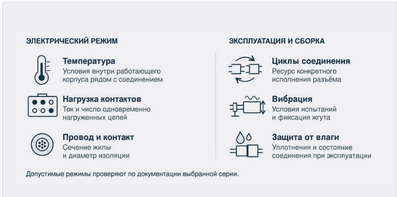
Рис. 2. Параметры нагрузки, эксплуатации и сборки, которые проверяют при выборе разъёма
