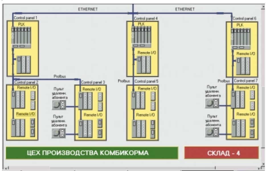
Рис. 3. Структура распределенной системы управления АС «Композит-2М» (уровень технологических станций)
