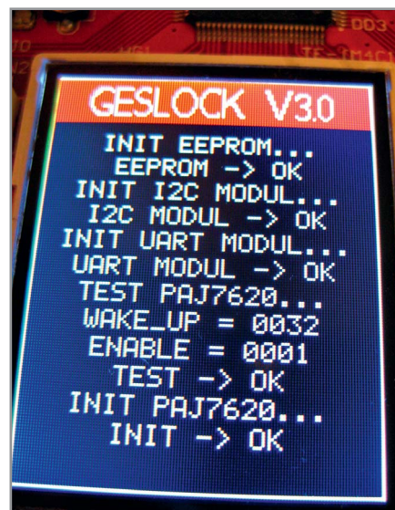
Рис. 8. Отображаемая на ЖКИ информация, соответствующая успешной инициализации датчика PAJ7620U2 и периферии МК
