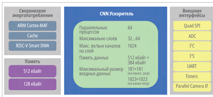
Рис. 1. Структура и основные характеристики ускорителя CNN ARM Cortex-M4 с FPU
