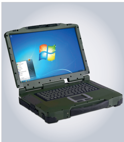
Рис. 5. Защищённый промышленный ноутбук TS STRONG MASTER 7020T
