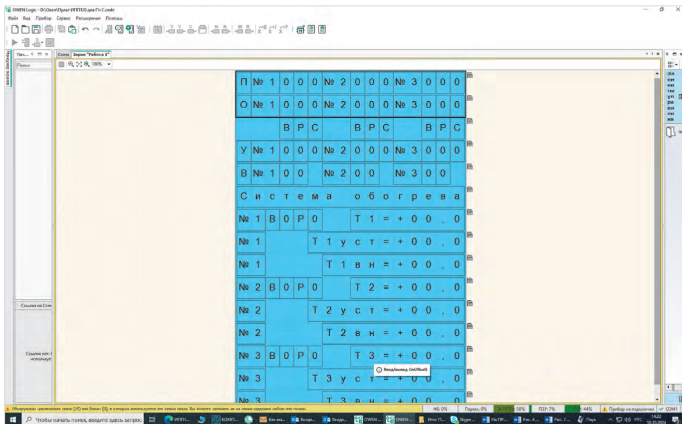
Рис. 7. Скриншот менеджера экранов ИПП120 АЗ в среде OWEN Logic
