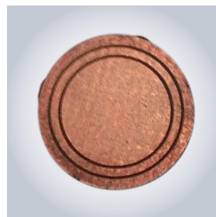
Рис. 7. RFID-метка IDN – 0101 на кольцевых щелевых резонаторах с двумя резонансными состояниями
