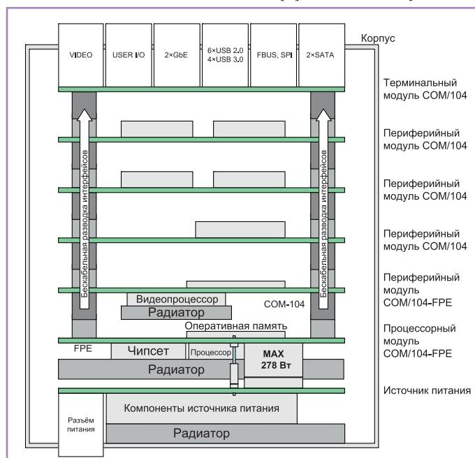
Рис. 1. Система СОМ/104 в индивидуальном корпусе
