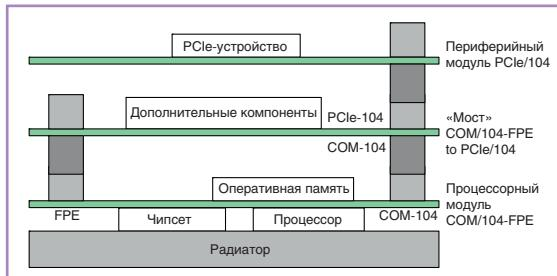
**Рис. 7. Использование мостового модуля типа COM/104-FPE to PCIe/104**
