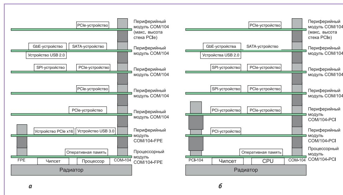
Рис. 6. Примеры организации стеков для COM/104-FPE (a) и COM/104-PCI (b)
