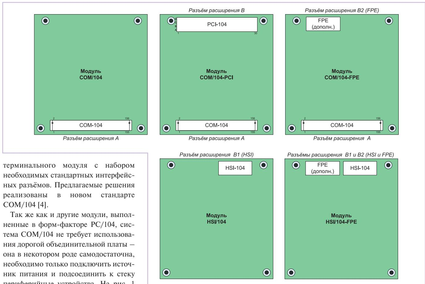
Рис. 2. Общий вид компоновки модулей COM/104
