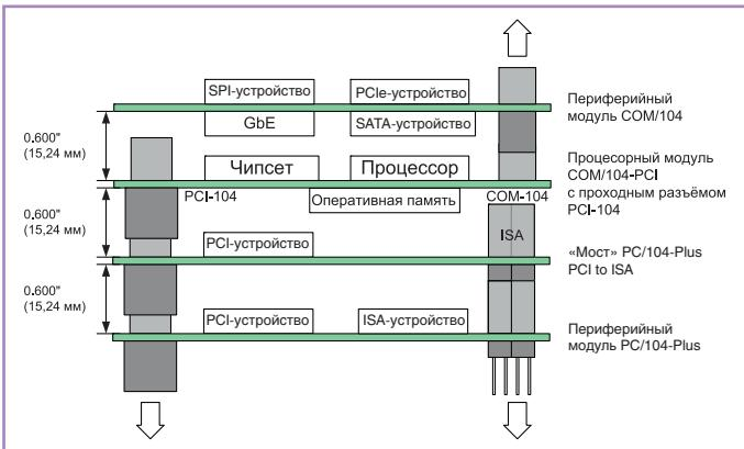
Рис. 5. Использование мостового модуля COM/104-PCI to PC/104
