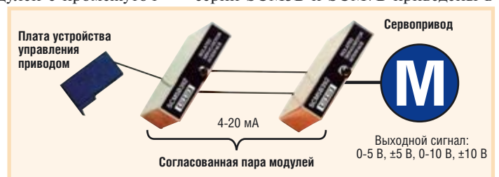
Рис. 3. Применение модулей SCM5B в цепи управления сервоприводом
