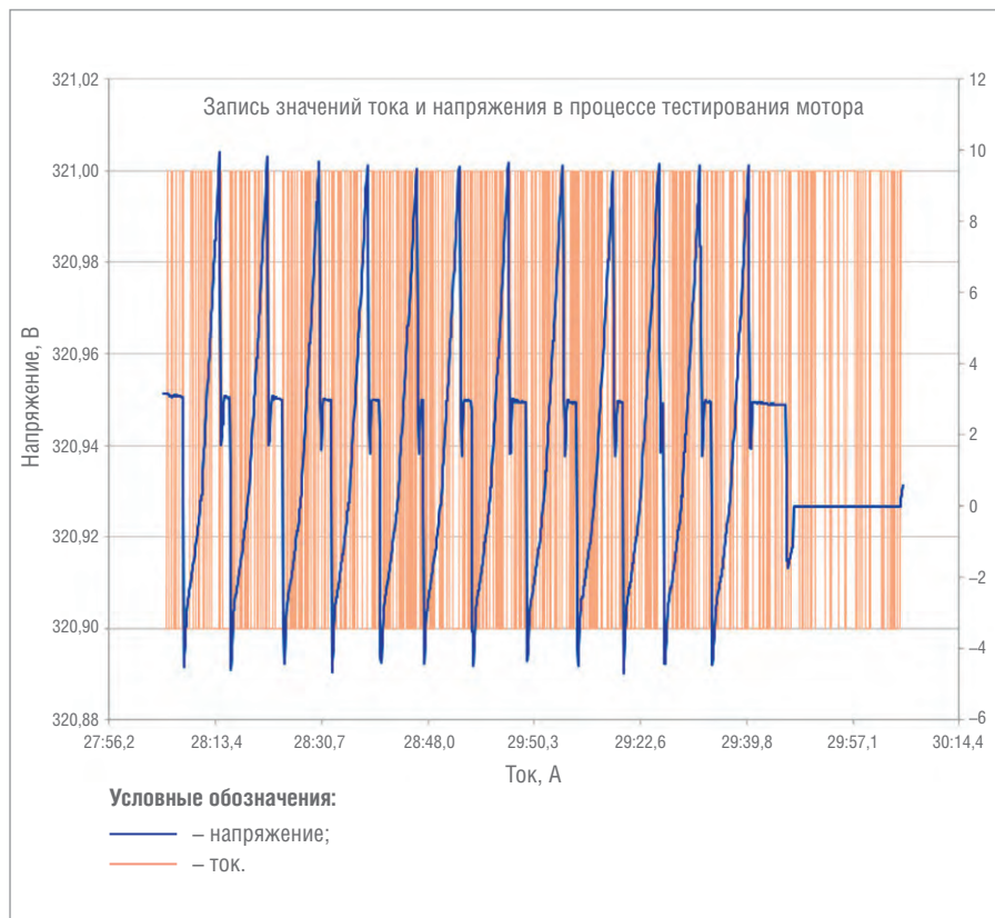
Рис. 11. Вольт-амперная характеристика 100-миллисекундных циклов испытаний
