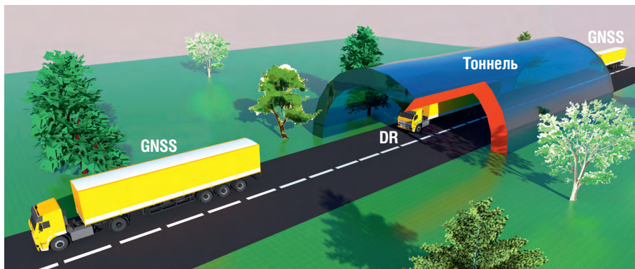
Рис. 5. Технология DR позволяет отслеживать транспорт в туннелях
