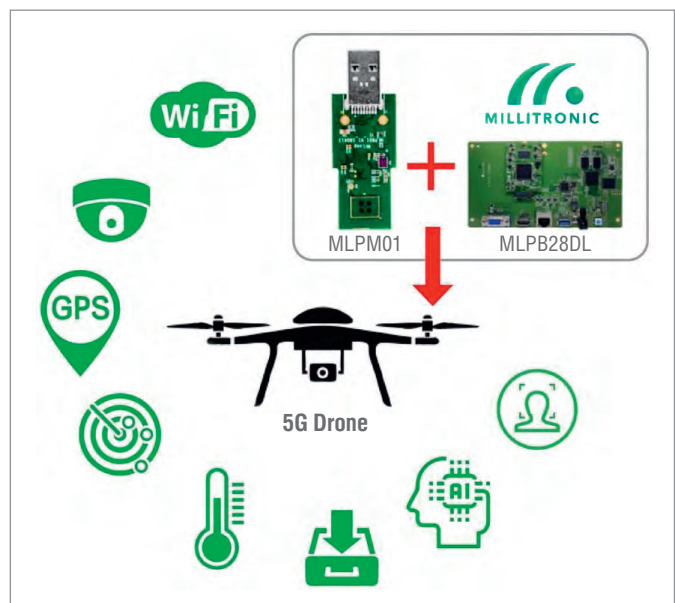
Рис. 2. Дрон с беспроводным гигабитным передатчиком
