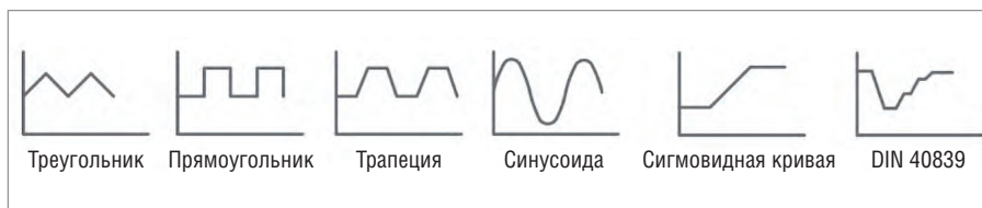
Рис. 9. Встроенные возможности функционального генератора
