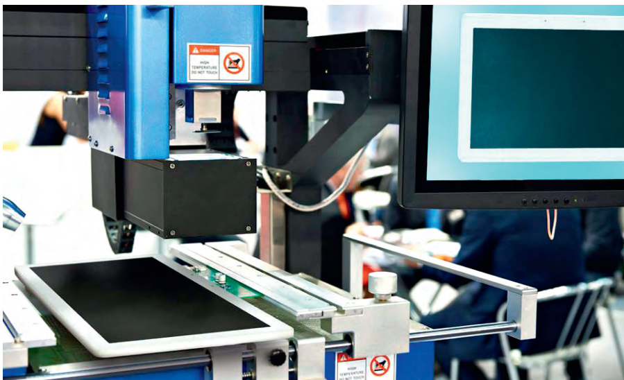
Рис. 6. Проверка качества ЖК-видеопанелей на конвейере
