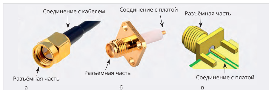
Рис. 1. Соединители SMA: кабельный (а), приборный коаксиально-микрополосковый соединитель (б), соединитель для поверхностного монтажа на печатную плату (в)
