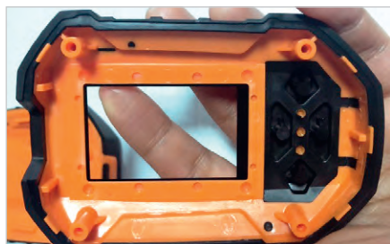
Рис. 4. Пример создания пластикового корпуса посредством ТПА
