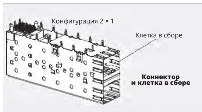
Рис. 3. Коннектор в раме, сторона монтажа на ППТ (или ППУ) сверху
