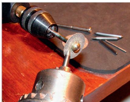
Рис. 34. Заточка керна на алмазном круге
