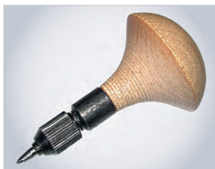
Рис. 24. Цанга с зажатым керном
