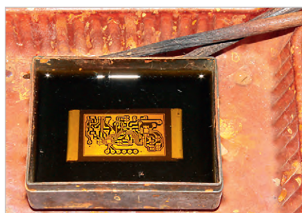
Рис. 23. Травление заготовки в хлорном железе
