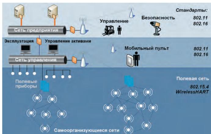
Рис. 1. Беспроводные решения Smart Wireless
