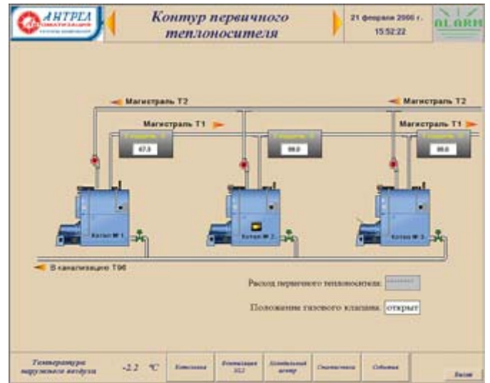
Рис. 7. Мнемосхема, отображающая состояние контура первичного теплоносителя котельной
