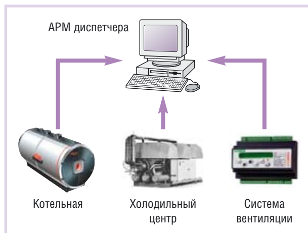
Рис. 1. Общая структура АСДУ инженерных сетей ТРК
