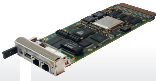
Рис. 2. Пример реализации AMC-модуля: ЦП PCIe NAMC-8569-CPU
