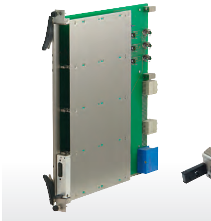
Рис. 1. Модуль AMC, присоединяемый к несущей плате ATCA
