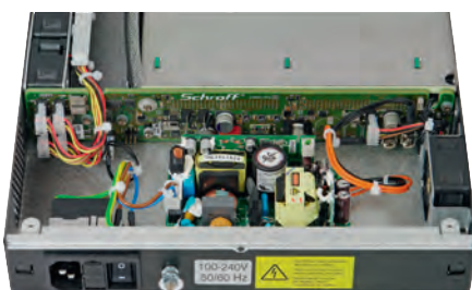
Рис. 8. Пример недорогой МТСА-системы с мезонинным модулем питания
