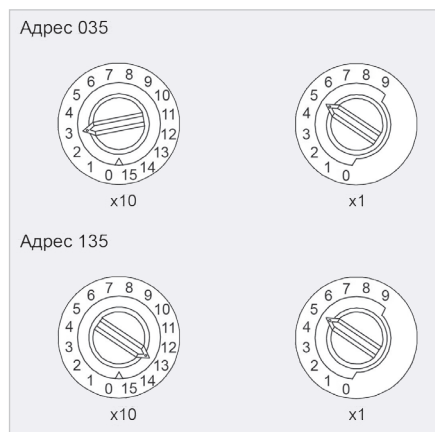
Рис. 6. Примеры установки конкретного кода для каждого пожарного оповещателя системы
