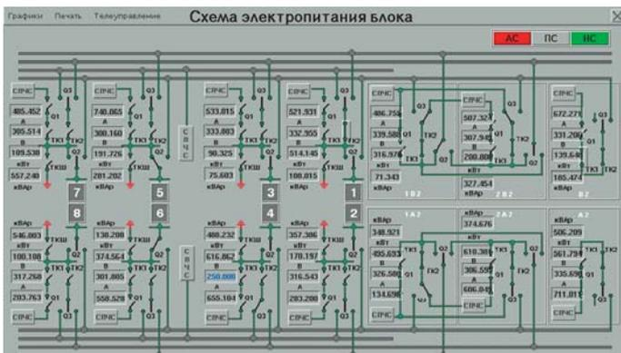
Рис. 4. Мнемосхема отображения состояния оборудования блока электропитания
