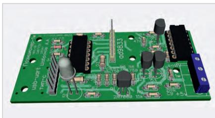
Рис. 7. 3D-модель печатной платы сканирующего адаптера 1wire
