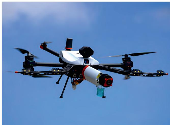
Рис. 4. Внешний вид дрона-манипулятора для забора проб воды
