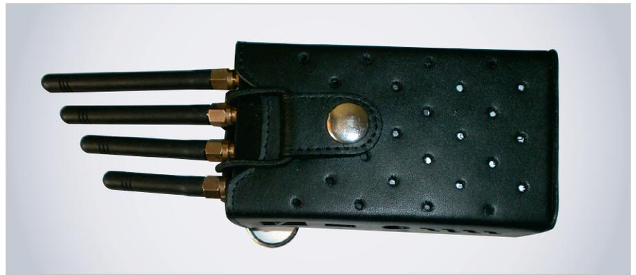
Рис. 10. Пример устройства глушения радиочастот для нейтрализации дронов малого форм-фактора
