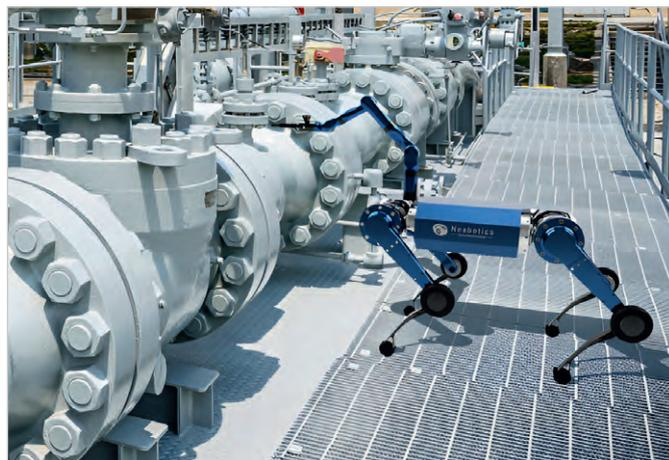
Рис. 7. Роботизированный комплекс от Neabotics
