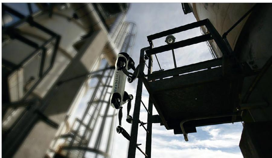
Рис. 1. Дрон-манипулятор для регламентных работ на ЛЭП
