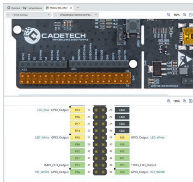
Рис. 4. Визуализация расположения разъёма на отладочной плате и назначение его выводов
