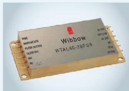
чиваемой схемой ограничения выходного тока до уровня 115% от максимального значения. Диапазон входного напряжения от 17 до 50 В. Типовое значение КПД 75% при полной нагрузке. Устройство предназначено для работы в диапазоне температур от  $-55^{\circ}\text{C}$  до  $+125^{\circ}\text{C}$  (на основании корпуса).
