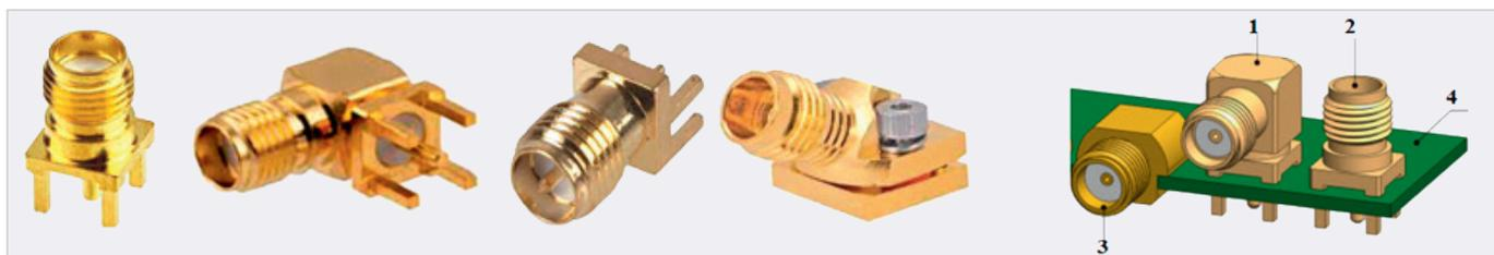
Рис. 5. Соединители SMA для установки на печатные платы: прямой (а), угловой (б), концевой (в), для установки без пайки с наклоном к плате (г); 1 – угловой, 2 – прямой, 3 – концевой соединители, 4 – печатная плата
