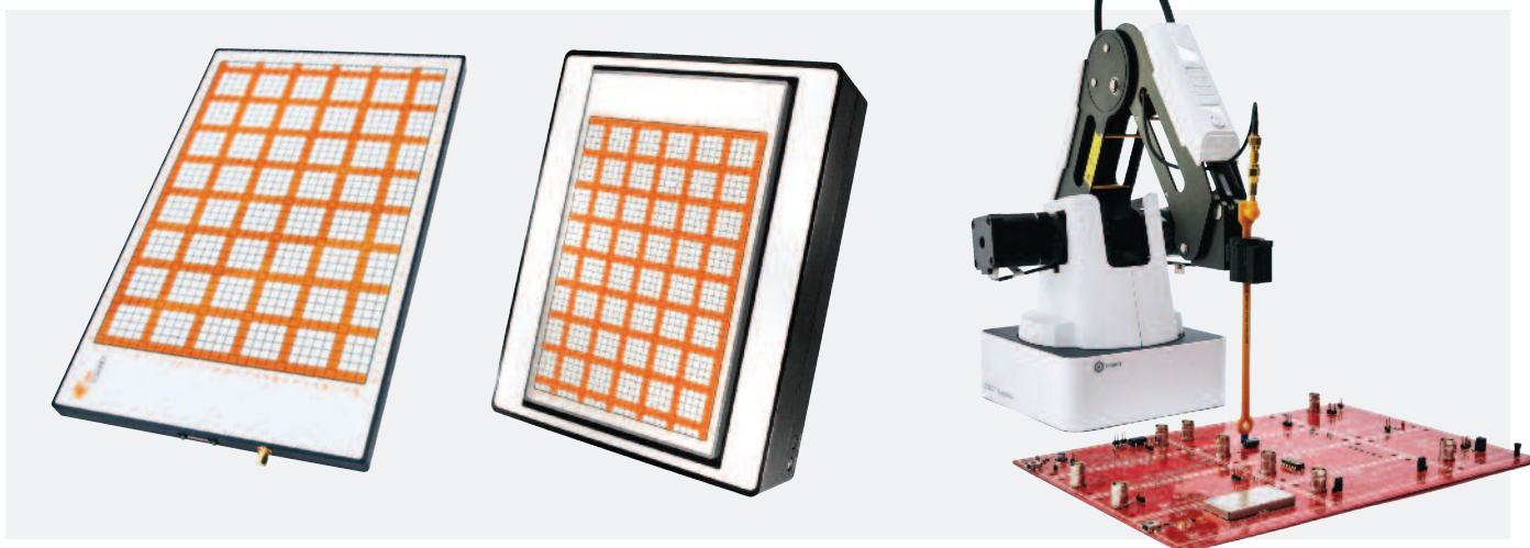
Рис. 1. Настольные сканеры для испытаний на помехоэмиссию (слева направо: EMScanner, EMScannerR и EMProbe)
