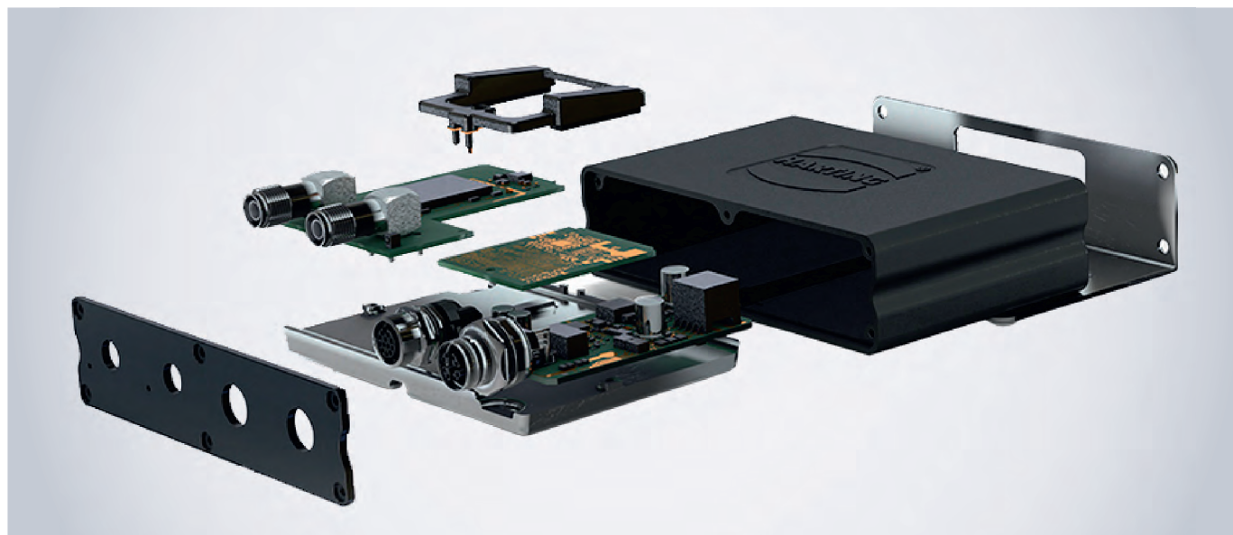
Рис. 3. Открытая компьютерная система HARTING MICA
