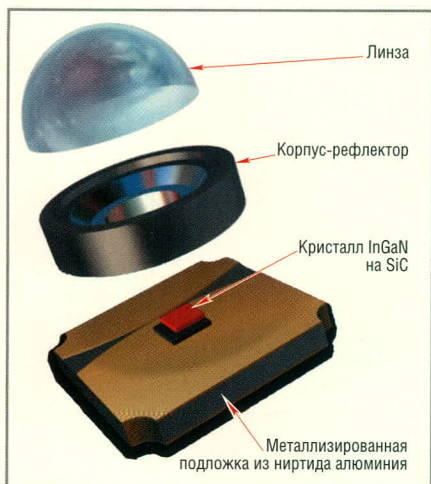
Рис. 5. Конструкция СЛ компаний CREE
