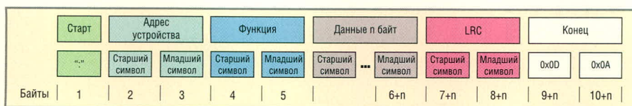
Рис. 7. Структура пакета, принимаемого ЦМ по протоколу MODBUS в режиме ASCII
