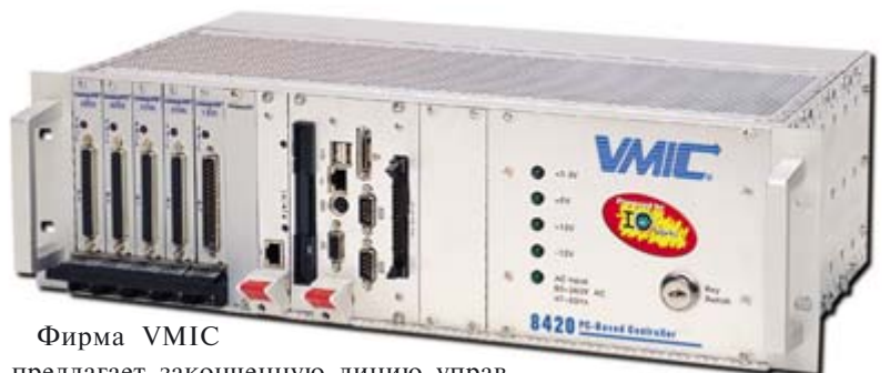
Законченное решение на базе CompactPCI с IOWorks
