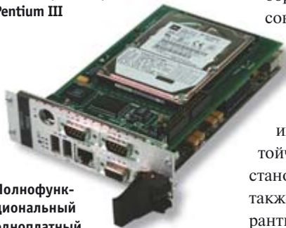
Полнофункциональный одноплатный компьютер VME на базе процессора Pentium III
