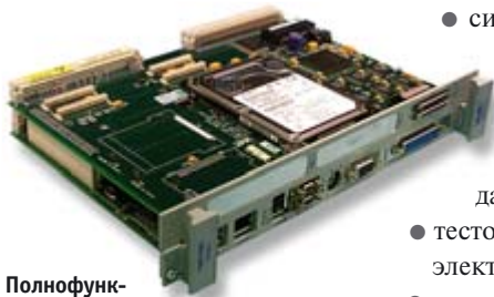
Полнофункциональный одноплатный компьютер VME на базе процессора Pentium III
