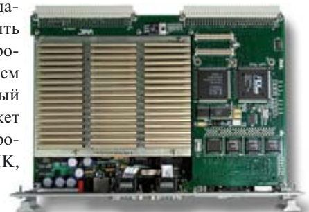
Pentium III 6U VME-контроллер шириной 4HP без вентилятора
