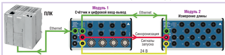
Рис. 3. Объединение двух интеллектуальных Ethernet-модулей MSX-E1701 и MSX-E3701 (фирма ADDI-DATA) для снижения нагрузки на ПЛК и организации приёма данных от энкодера
