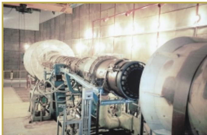
Испытательный бокс с двигателем
