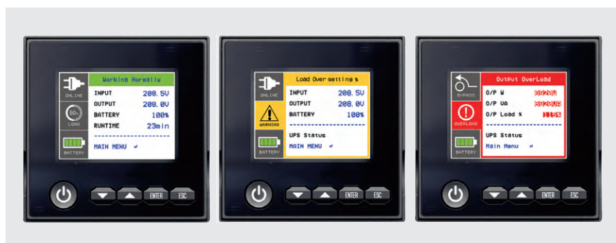
Рис. 3. Цветовая индикация состояния устройства на панели
