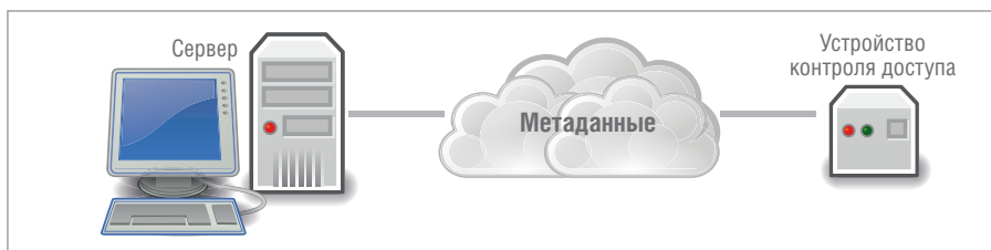
Рис. 4. Вариант анализа видеопотока на устройстве контроля доступа
