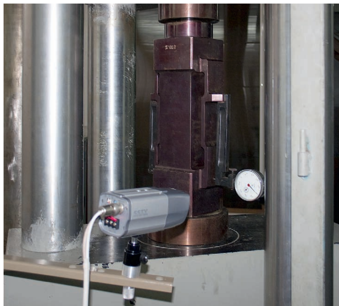
Рис. 4. Фрагмент установки с размещённой видеокамерой при поверке динамометра ДЭС-2000
