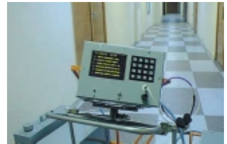
Рис. 5. Дисплей Planar EL640.480.AM8-ET в составе дефектоскопа АДС-02
