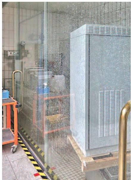
Рис. 12. Испытания шкафа на герметичность (степень защиты IP55)
