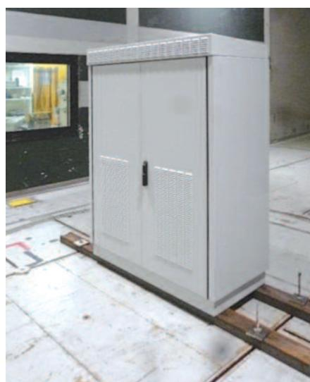
Рис. 11. Модульный шкаф в ветровом туннеле
