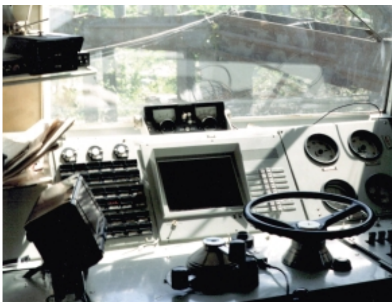
Рис. 5. Блок ввода информации и индикации БИ1 в кабине машиниста
