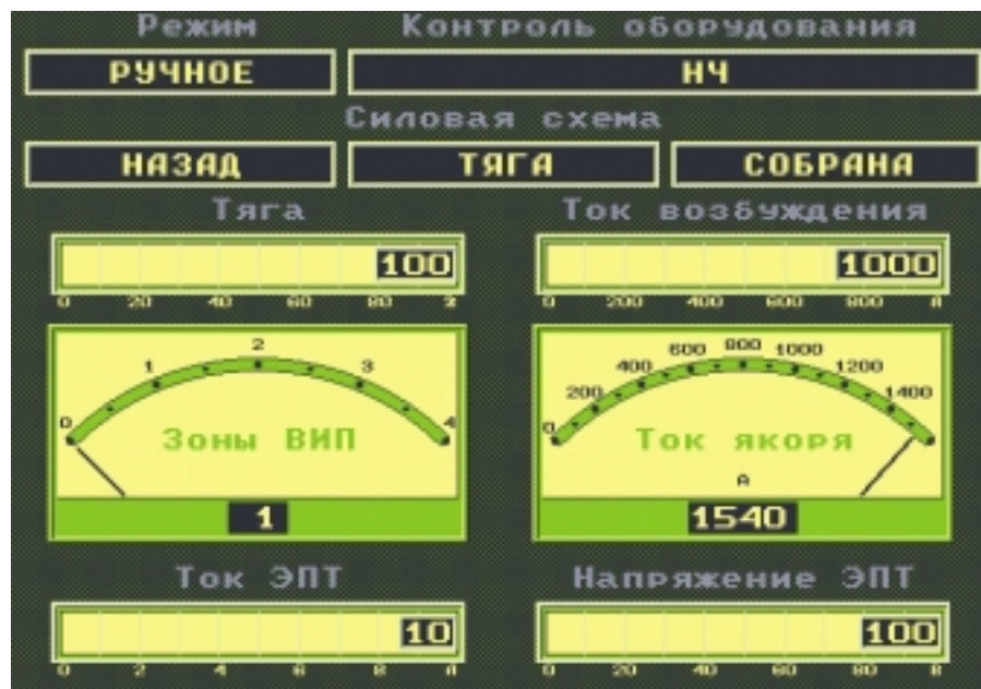
Рис. 3. Отображение технологической информации на дисплее пульта машиниста
