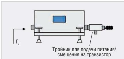
Рис. 3. Выходная цепь базовой пассивной load-pull-установки
