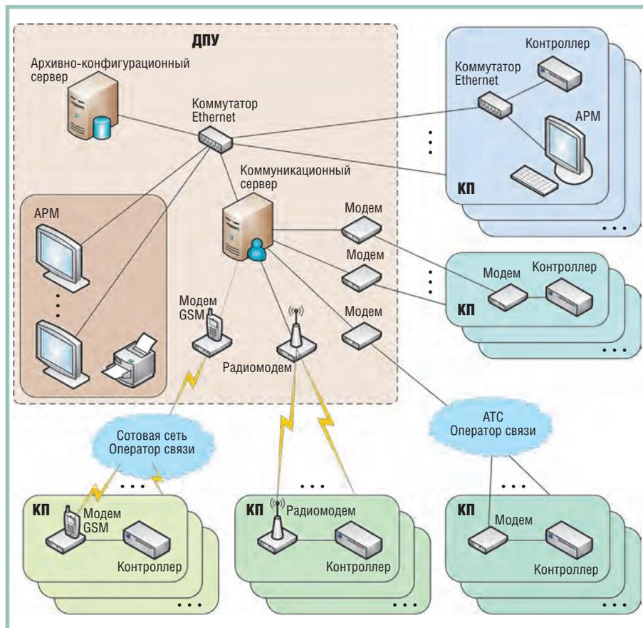
Рис. 1. Структурная схема СТМ
