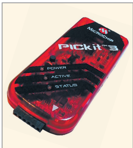
Рис. 5. Недорогой «народный» внутрисхемный программатор-отладчик PICkit3
