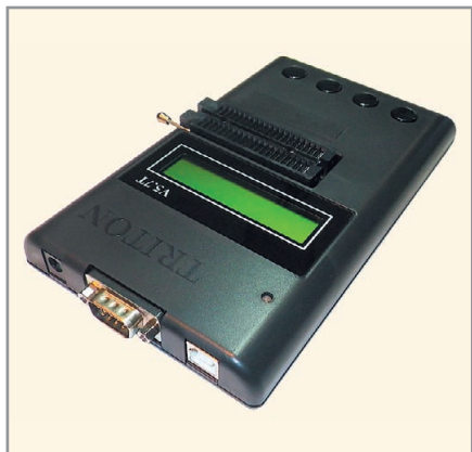
Рис. 4. Программатор Тритон v5 7T
