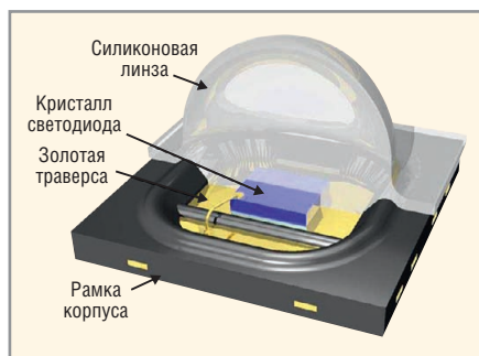
Рис. 2. Структура светодиодов серии OSOLON Black Series
