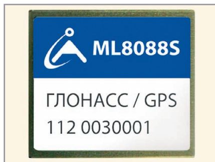
Рис. 4. ГЛОНАСС-модуль НАВИА ML8088S
