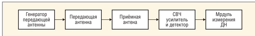
Рис. 2. Структурная схема измерения ДН антенны
